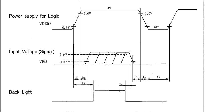
POWER ON  $t_1 \le 15 \text{ms}$  $0 \text{ms} < t_2 \le 45 \text{ms}$  $0. 1s \le t_3$
